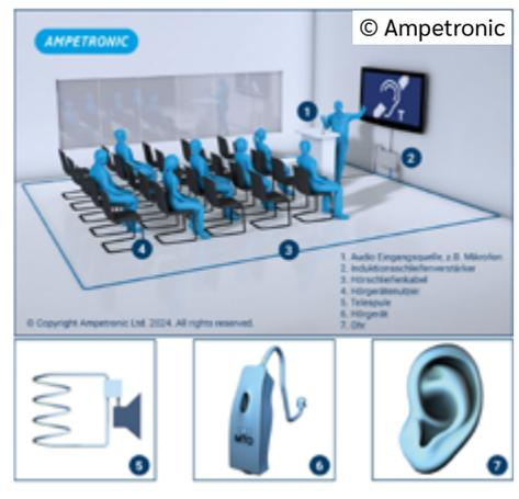
Funktion einer Induktionsschleife – der Ton aus dem Mikrofon wird direkt auf das Hörgerät übertragen.
